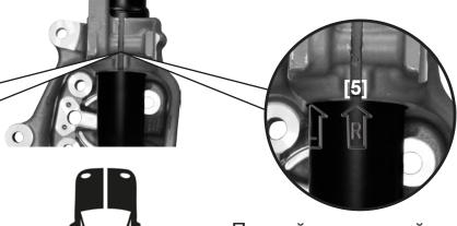
Правый поворотный кулак: Установить амортизатор так, чтобы стрелка «R» и выемка лежали на одной прямой [5].
