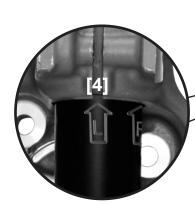
Левый поворотный кулак: Установить амортизатор так, чтобы стрелка «L» и выемка лежали на одной прямой [4].
