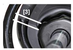
Правильное положение пружины: край опоры пружины и конец пружины должны располагаться относительно друг друга, как показано на рис. [3]. При полной сборке необходимо соблюдать указания производителя автомобиля.
