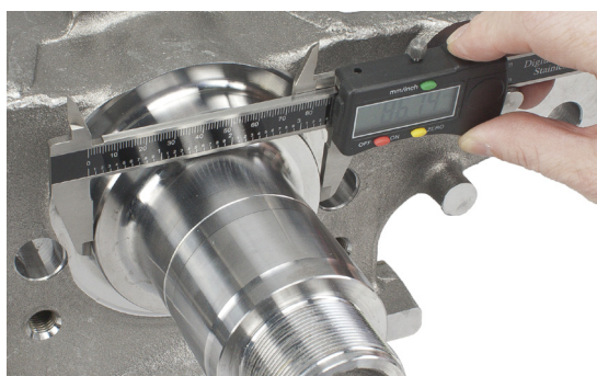
Рис. 2: Для точного определения необходимого защитного кольца проведите измерение седла ступицы
