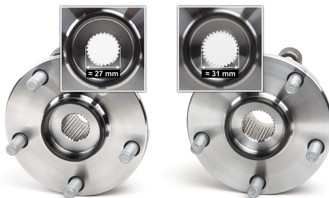
Рисунок 2: Разный диаметр шлицев ШРУСа.
