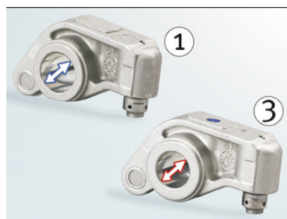
Рис. 2: Диаметр коромысла больше со стороны впуска (1)
