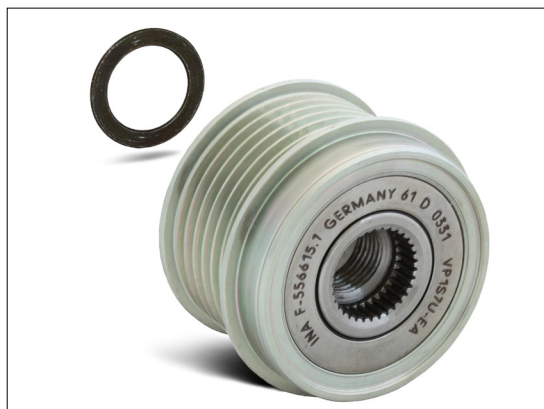
Рисунок 2: При установке шкива генератора с обгонной муфтой на генератор Bosch, необходимо использовать шайбу толщиной 1.4 мм, прилагающуюся в комплекте.
