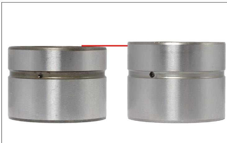
Рисунок 1: Гидрокомпенсатор: слева: прежняя версия, справа: новая версия
