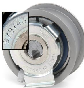
Рисунок 1: 531 0777 10 – натяжной ролик прежней конструкции (979743)
