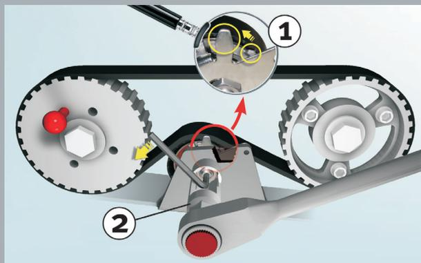
Рис. 1: Обзор привода и положений натяжного ролика и специнструмента
