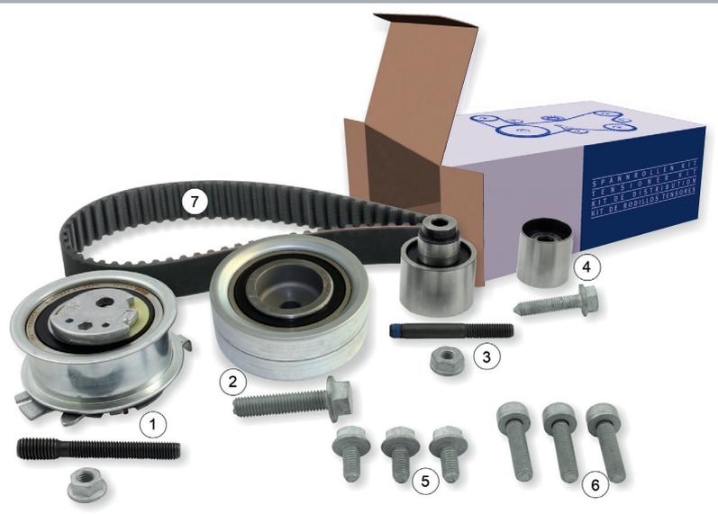
Рис. 1: Комплект Ruville натяжного ролика 5634970
