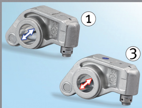
Илл. 2: На стороне впуска (1) диаметр коромысла больше
