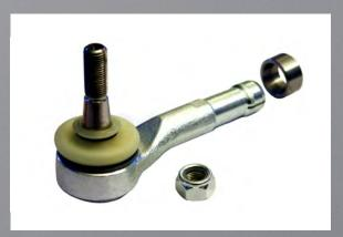
**Илл. 1:** 918619 – наконечник поперечной рулевой тяги с зажимным ко льцом и гайкой
