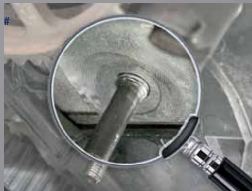
1. Шпилька ввинчена неправильно.
