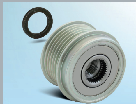
Рис. 2: При установке механизма свободного хода на генератор Visteon (Ford Mondeo III) необходимо использовать прилагаемую промежуточную шайбу толщиной 3 мм!
