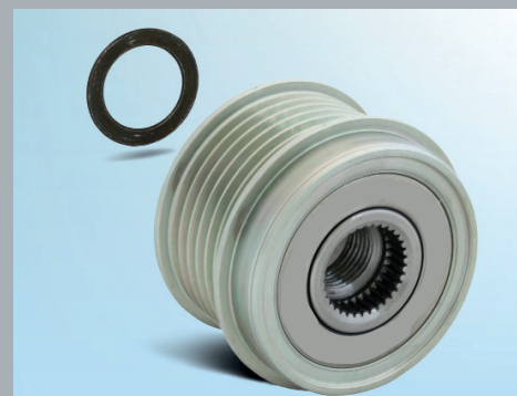
Рис. 3: При установке механизма свободного хода на генератор Bosch (Ford Mondeo III) необходимо использовать прилагаемую промежуточную шайбу толщиной 3 мм!
