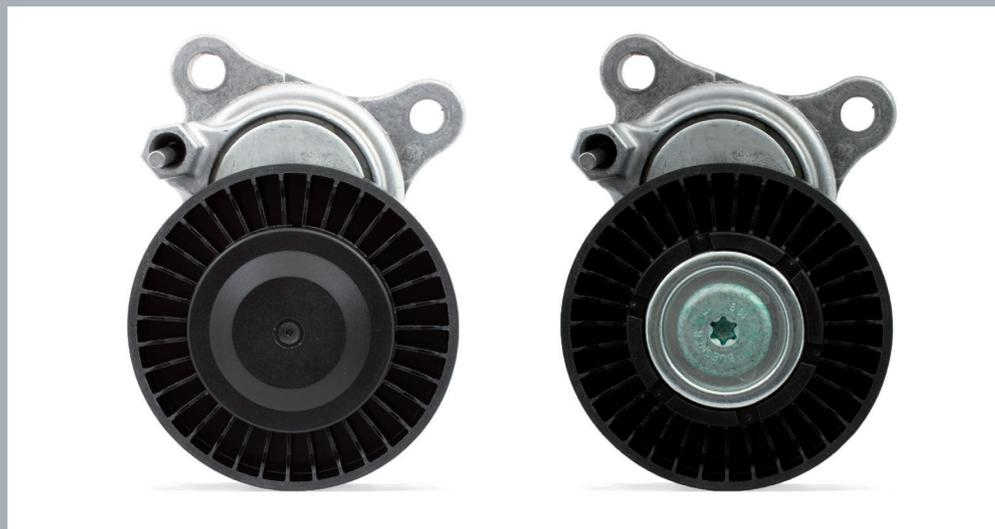
Рис. 1: Слева – старая модификация, справа – новая модификация
