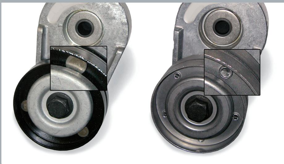
Рис. 1: Детальный вид ходовых роликов прежней модификации (слева) и новой модификации (справа)
