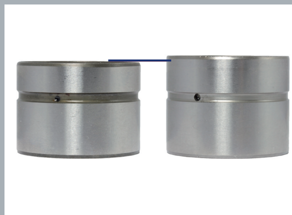
Рис. 1: Слева: гидравлический тарельчатый толкатель старой модификации. Справа: толкатель новой модификации.
