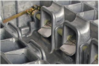
Обзор внутренней конструкции системы регулируемого воздухозаборника
