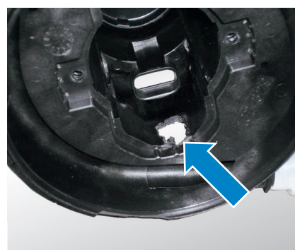
Признаки повреждения: следы оплавления на корпусе (вид сверху внутрь корпуса)
