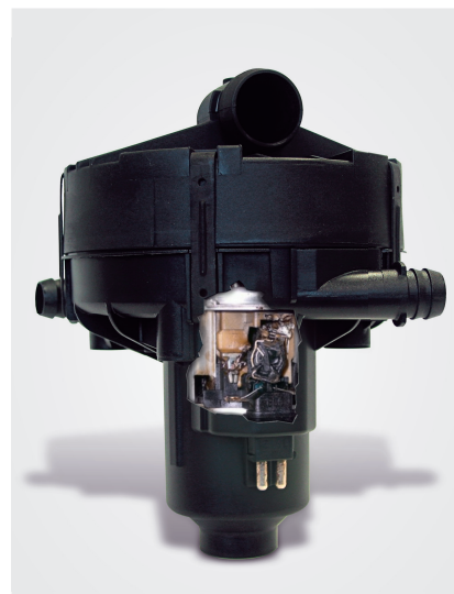
Вид на внутреннюю часть насоса вторичного воздуха (в разрезе) со следами оплавления
