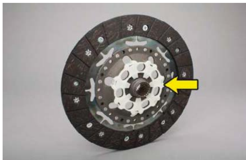
Рис. 1: Ведомый диск сцепления с пластиковым кольцом
